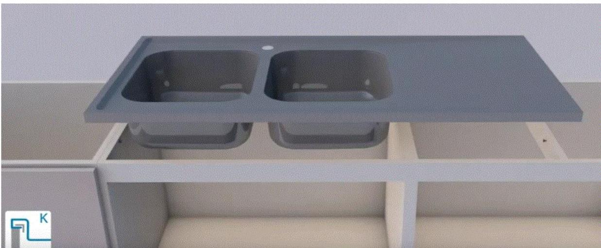
3. Setzen Sie den schwarzen Befestigungswinkel auf die Schraube. Oberer Teil des Winkels auf den unteren Rand der Auflagespüle.
